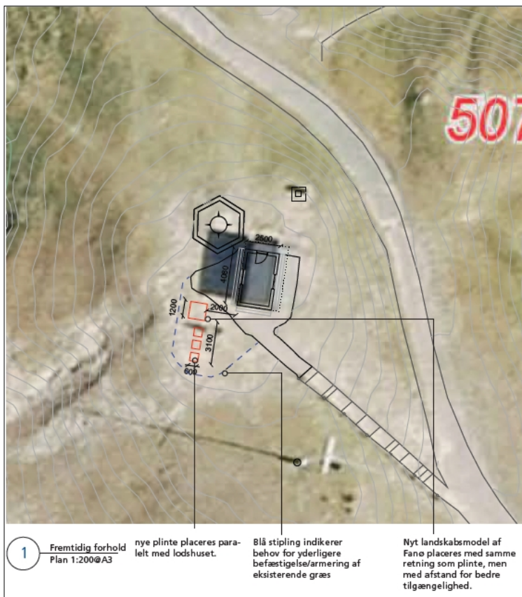
Fig. 6: Skitse med angivelse af, hvor plintene placeres og området der befæstes med græsarmingssten.
